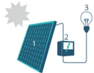
1. Zonnepaneel | 2. Omvormer | 3. Elektrische toestellen
