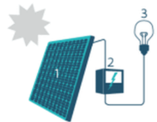
1. Zonnepaneel | 2. Omvormer | 3. Elektrische toestellen
