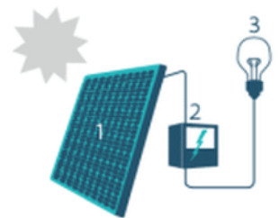
1. Zonnepaneel | 2. Omvormer | 3. Elektrische toestellen
