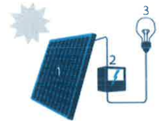
1. Zonnepaneel | 2. Omvormer | 3. Elektrische toestellen
